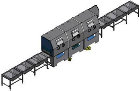
Durchgängige Dreifach-Strahlkabine mit integrierter Rollenbandförderung und Schiebetüröffnung.
