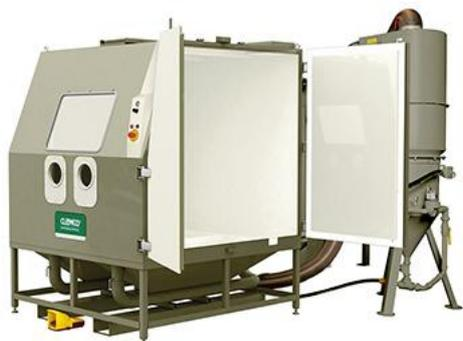
Ce produit de haute qualité fait partie de la gamme des cabines de sablage. Les cabines de sablage Clemco sont idéales pour l'usinage des pièces petites à moyennes. Le sablage dans les cabines est un procédé particulièrement écologique qui garantit une efficacité et une sécurité maximales.
